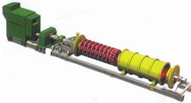
Hình 3. Sơ đồ nguyên lý máy nghiền IsaMill
